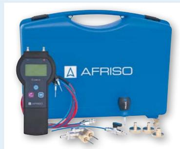
**Application** Pour la mesure de la pression différentielle et le réglage du débit dans les installations de chauffage et de climatisation dans le cadre de l'équilibrage hydraulique. A utiliser en combinaison avec les robinets thermostatiques et les blocs combinés VarioQ. Sur les robinets VarioQ, l'équilibrage hydraulique peut directement être effectué sur le radiateur. La connaissance du réseau des tuyauteries n'est pas nécessaire, les calculs fastidieux sont supprimés.
