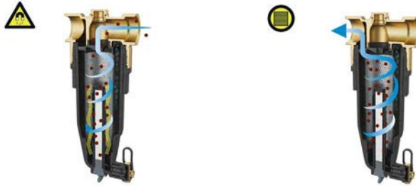
Abbildung 13. Filterstufen des Mediums im ADS 181-Abscheider
