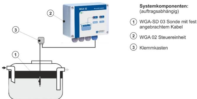
Abbildung 4: Alarmsystem für Ölabscheider mit WGA 02
