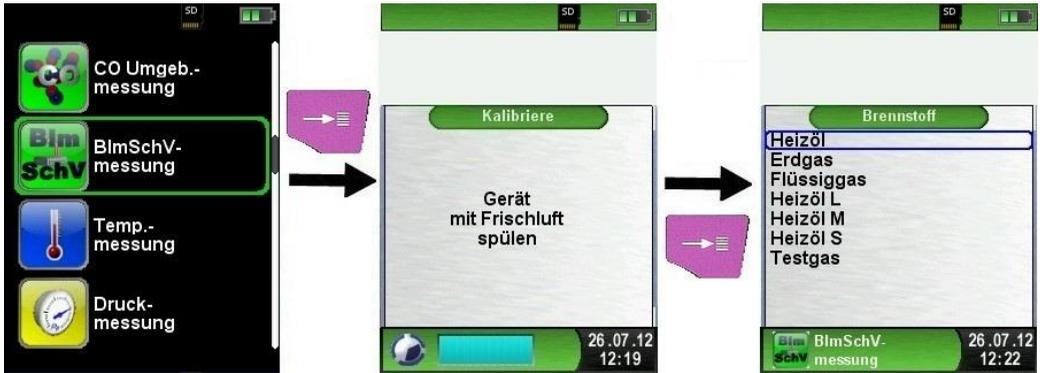
Danach wird die Abgassonde ins Kamin- bzw. Abgasrohr eingeführt. Wenn der O<sub>2</sub>-Wert unter 20% sinkt und beide Temperaturfühler angeschlossen sind, dann wird die 30 Sek. Mittelwertmessung gestartet. Nach den 30 Sekunden wird der berechnete qA-Wert angezeigt. Die qA-Mittelwertmessung läuft kontinuierlich weiter.
