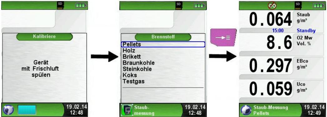
Nun müssen die Parameter am Staubmessgerät gewählt werden. Sobald das Staubmessgerät bereit ist, wird dies auch im MULTILYZER® STe dargestellt. Jetzt kann die Messung entweder am Staubmessgerät oder am MULTILYZER® STx gestartet werden.
