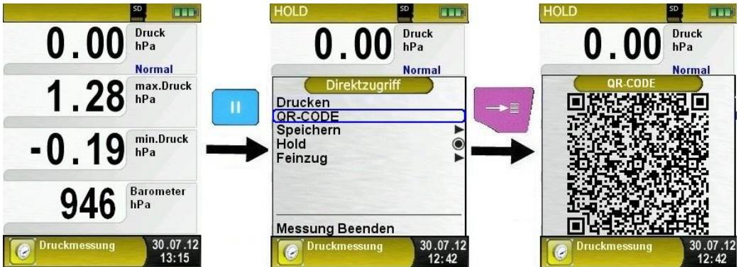
Bild 9: QR-Code generieren, Bsp.: Druckmessung
