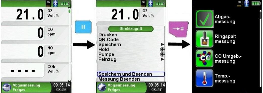
Nun kann die nächste Messung durchgeführt werden. Die Messung muss wiederum mit „Speichern und Beenden“ geschlossen werden.
