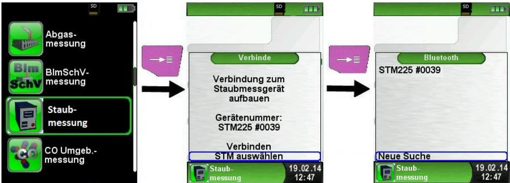
Mit der Auswahl „Neue Suche“ wird die Bluetooth Suche aktiviert und alle gefunden Geräte werden gelistet. Nun muss das STM 225 ausgewählt werden. Das gewählte Gerät wird vom MULTILYZER® STx automatisch gespeichert. Dieses wird standardmäßig bei weiteren Messungen verwendet. Mit „Verbinden“ wird das Messverfahren gestartet.
