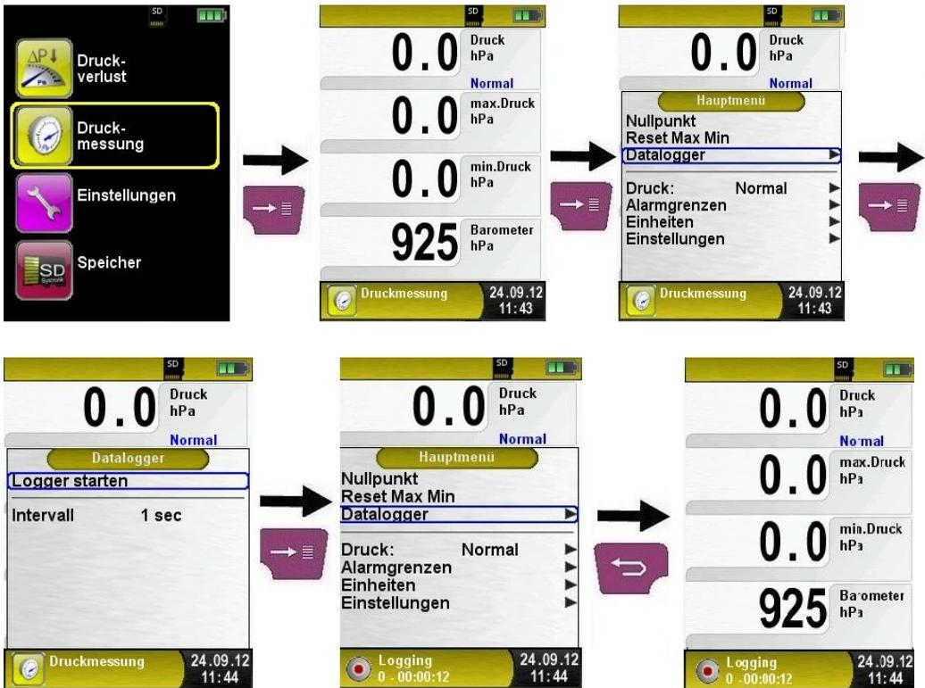
Die Dauer der Datenerfassung (Datalogger) wird in der Informationszeile angezeigt.
