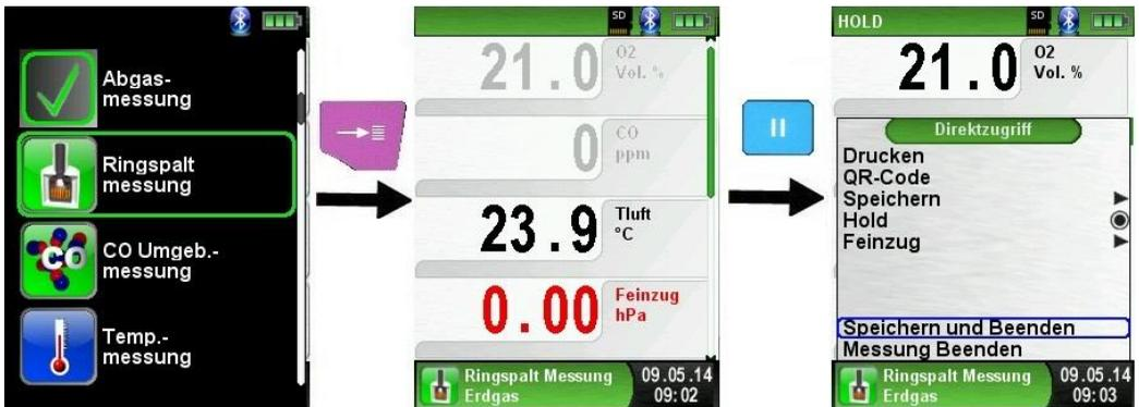
Dies kann mit allen verfügbaren Programmen wiederholt werden. In diesem Beispiel sind die Messdaten aus der Abgasmessung und der Ringspaltmessung zusammengeführt. Nun können über die „HOLD“ Taste die Messdaten gedruckt, gespeichert oder als QR-Code
