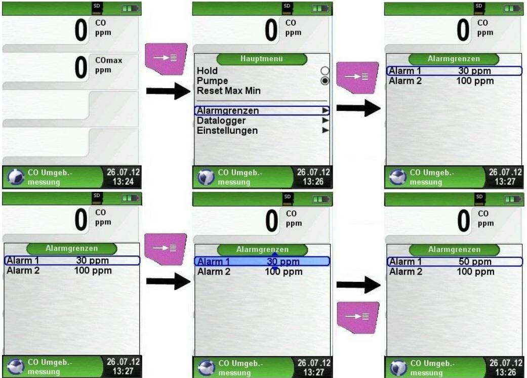
Wenn der gemessene CO-Wert eine der Alarmschwellen übersteigt, ertönt ein Alarmton und der CO-Wert wird bei Überschreitung der 2. Alarmschwelle rot angezeigt.
