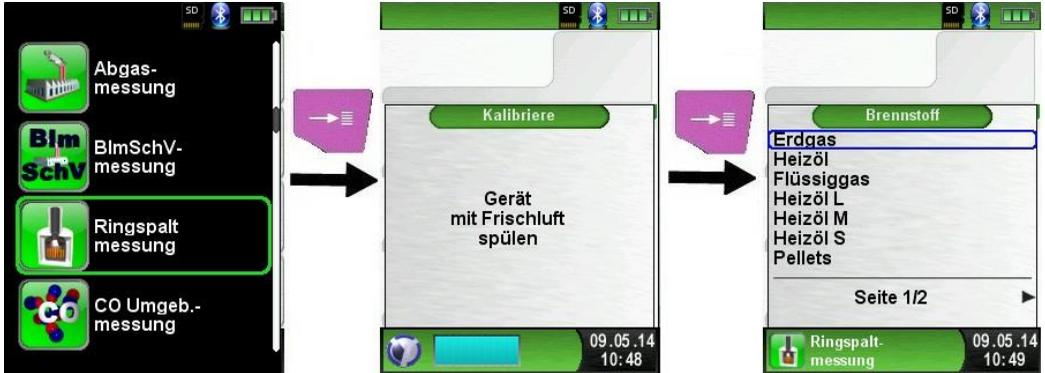
Es kann sowohl eine CO-Messung nach KÜO (Kehr- und Überwachungsordnungen der Bundesländer) als auch eine Ringspaltmessung (O<sub>2</sub>-Differenz im Ringspalt) durchgeführt werden. Somit wird ermittelt, ob Abgase in die Verbrennungsluft gelangen. Dazu gibt es als Zubehörartikel die Ringspaltsonde.
