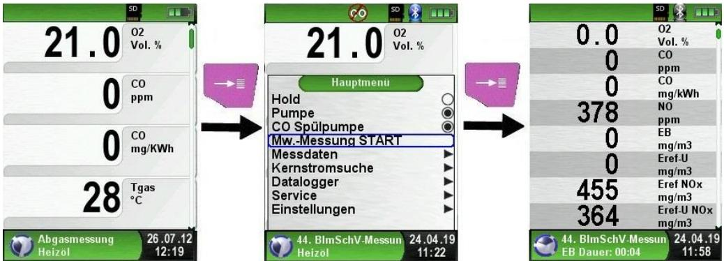
Am Ende der Messung kann das Ergebnis ausgedruckt oder auf der MicroSD-Karte gespeichert werden.
