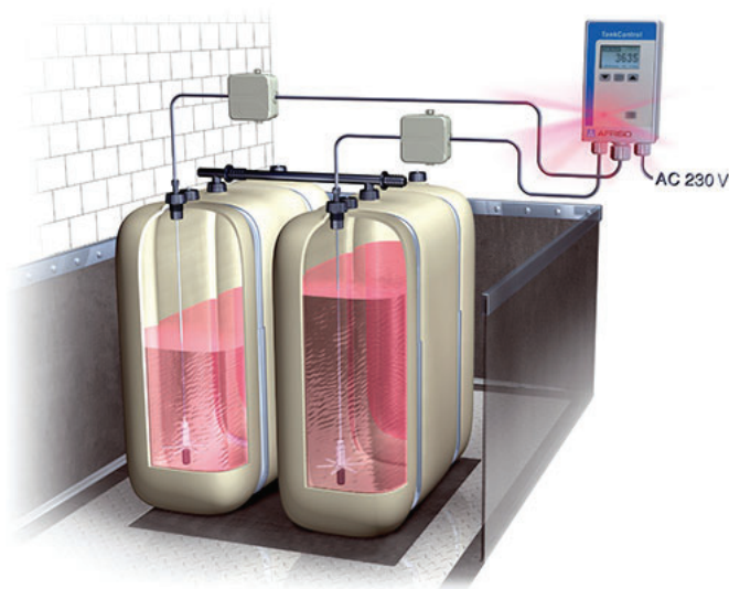
Ilustracja 6: Pomiar poziomu napelnienia z rejestracją różnicy w baterii zbiorników
