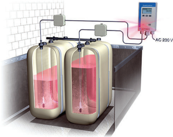
Abbildung 6: Füllstandmessung mit Erfassung der Differenz an Batterietanks
