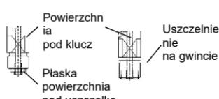
Moment obrotowy zależy od zastosowanego uszczelnienia. W celu uzyskania położenia manometru, które umożliwia łatwy odczyt, połączenie gwintowane powinny być wykonane za pomocą połączenia gwintu zewnętrznego ze stałym gwintem wewnętrznym lub z nakrętką.
