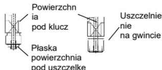
Moment obrotowy zależy od zastosowanego uszczelnienia. W celu uzyskania położenia manometru, które umożliwi łatwy odczyt, połączenie gwintowane powinny być wykonane za pomocą połączenia gwintu zewnętrznego ze stałym gwintem wewnętrznym lub z nakrętką.
