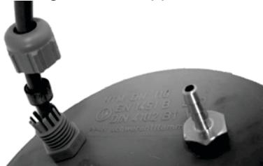
6. Die erforderlichen Sonden-, Saug- und Messleitungen von unten an der HT-Kappe montieren oder durchführen. Sonden- und Messleitung in der richtigen Höhe (ca. 20–30 cm über dem Tankboden) mit der PG-Verschraubung justieren und gegebenenfalls kürzen.
