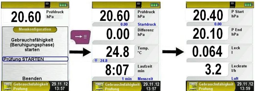
Am Ende der Druckmessung ertönt ein Signal und in der Informationszeile wird das Ergebnis angezeigt. Die Messwerte werden in der Hauptanzeige festgehalten und man kann das Messprotokoll speichern oder ausdrucken, wie im folgenden Bild ersichtlich.
