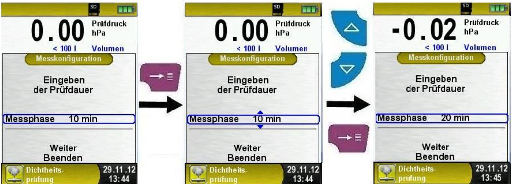
Bild 7: Messkonfiguration ändern, Bsp.: Änderung der Prüfdauer
