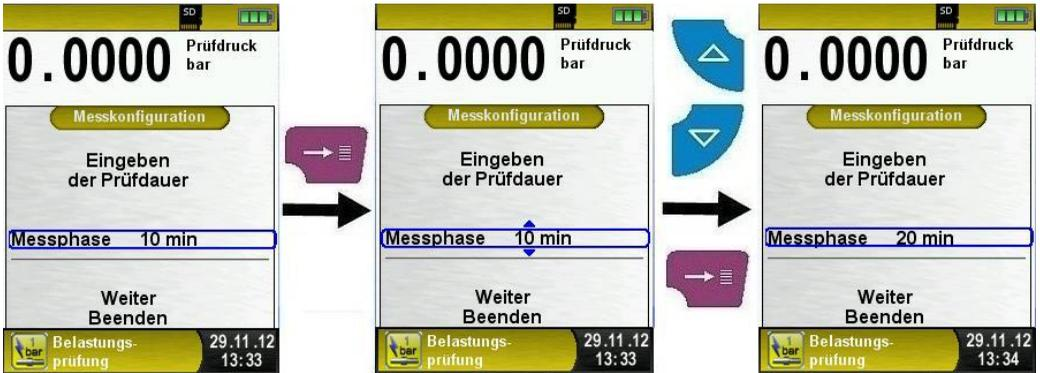
Bild 6: Messkonfiguration ändern, Bsp.: Änderung der Prüfdauer
