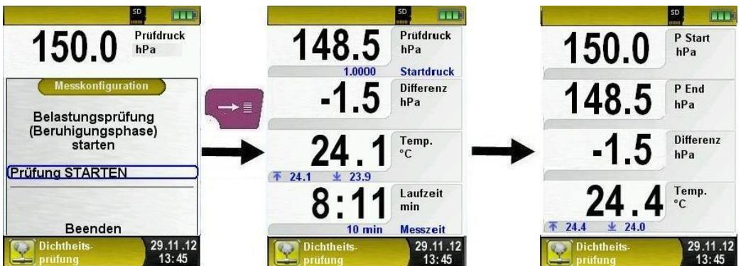
Am Ende der Dichtheitsmessung ertönt ein Signal und in der Informationszeile wird die Meldung „Prüfung beendet“ angezeigt. Die Messwerte werden in der Hauptanzeige festgehalten (HOLD-
