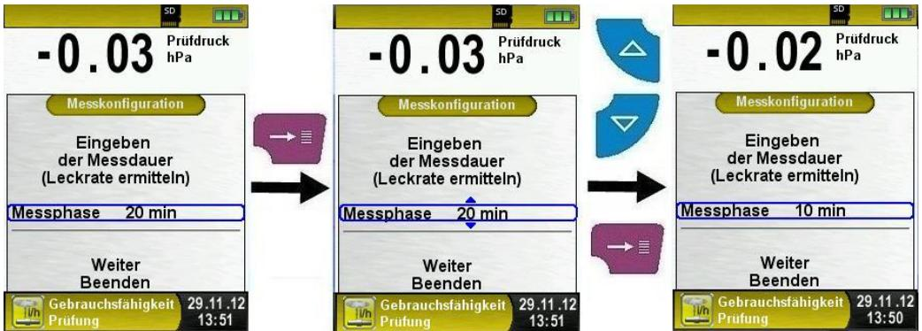
Bild 8: Messkonfiguration ändern, Bsp.: Änderung der Prüfdauer
