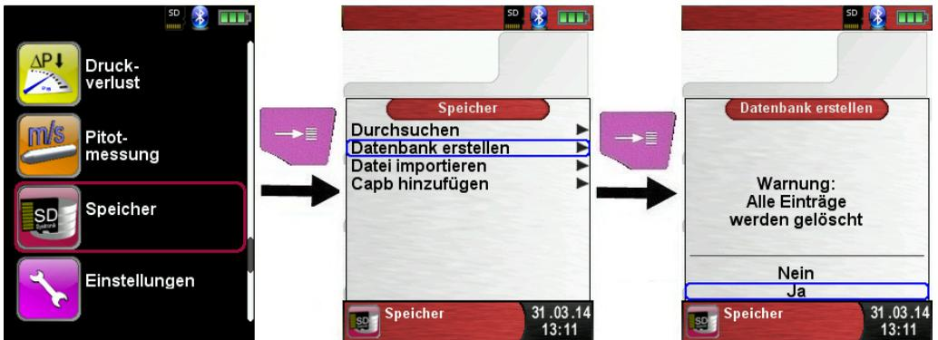
Bei der Prozedur wird auf der MicroSD-Karte eine DATABASE.CSV Datei erstellt, dies stellt die Speicherstruktur des Druckmessgerätes DPK 60-7 ST dar. Die Prozedur dauert wenige Sekunden.
