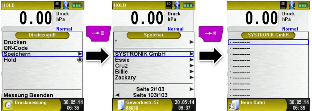
Die gespeicherte Datei kann man folglich anzeigen, ausdrucken oder gegebenenfalls auch mit einer neuen Messung überschreiben. Der Dateiname und Speicherort jeder Messung wird im unteren Info Bereich dargestellt. In diesem Beispiel: Speicherordner: MEMORY/0000 und Dateinamen 0000\_00.txt:
