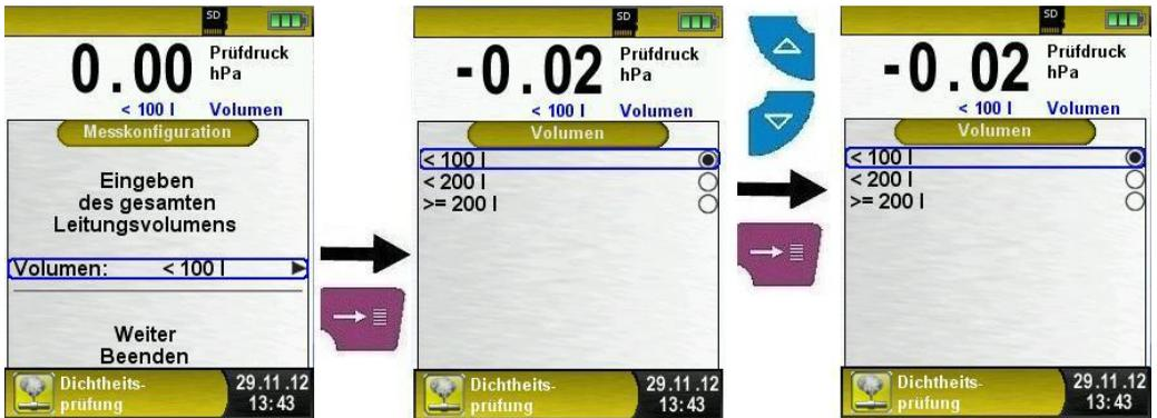
► Messkonfiguration ändern (Dauer der Beruhigungsphase, Dauer der Prüfdauer, Prüfmedium).
