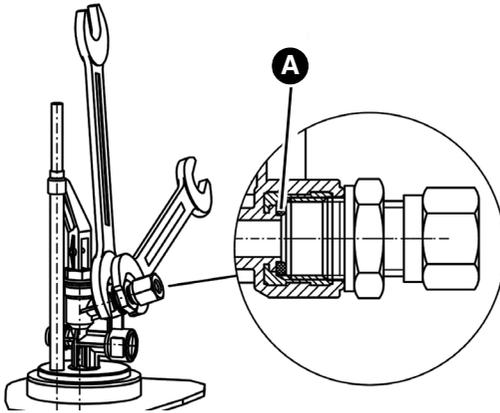
1. Legen Sie den O-Ring  $\varnothing 9 \times 3$  mm (A) in das Anschlussstück ein.
