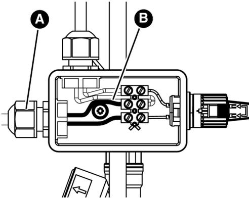
3. Schließen Sie die isolierte Litze (B) (braun oder schwarz) des Kabels an eine der beiden freien Klemme an.
