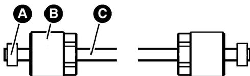
8. Schieben Sie die Überwurfmutter (B) und Dichtringe (A) von beiden Seiten auf das Entnahmerohr (C).
