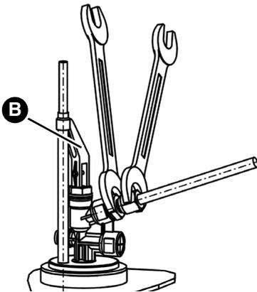
4. Führen Sie das Rohr in die Rohrverschraubung ein.
