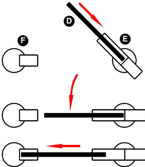
9. Montieren Sie das Entnahmerohr (D) an die Erweiterung (E).
