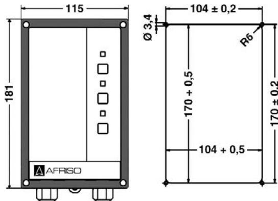
Fig. 7 : Unité de commande avec cadre de montage pour installation dans un panneau de commande. A droite : Découpe du tableau de commande
