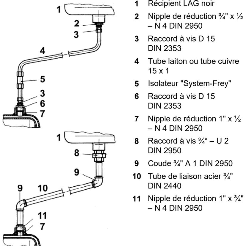
Fig. 6 : Exemple de montage - tube de liaison LAG
