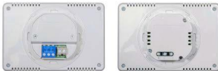
Abbildung 1 : Abtrennen der Rückseite des Thermostats.
