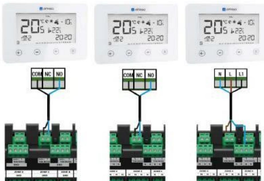
Betrifft die Batterieversion: Abbildung 8: Elektrischer Anschluss des Thermostats RT05 an die Leiste WB01 D-8-24V
