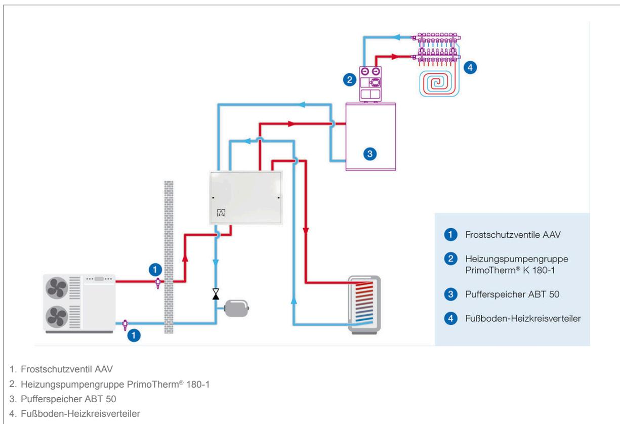
1. Frostschutzventil AAV
